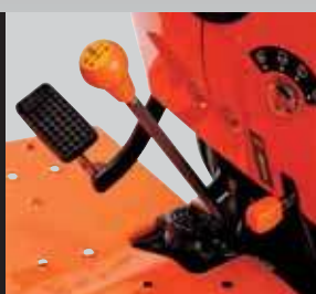
Cambio de velocidad principal parcialmente sincronizado
