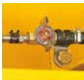
Válvula de drenaje de combustible
