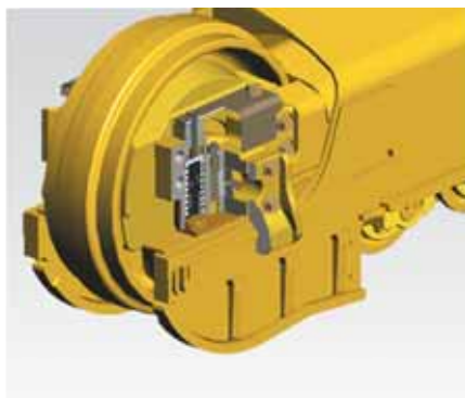
Apoyo de la rueda guía auto ajustable
