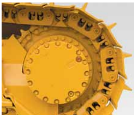
Ruedas dentadas segmentadas
