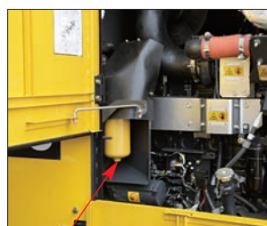
Filtro de la transmisión enroscable
